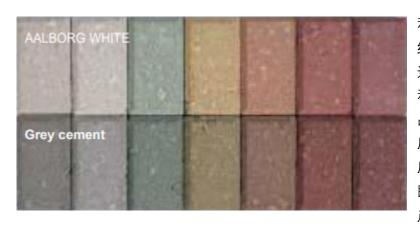
利用阿尔博白水泥的高 纯度和稳定性,GRC制 造商可以生产出高性能 和颜色稳定的构件成 品。白水泥的高纯度和 质量稳定,是生产高品 质彩色产品的关键—— 即使是灰色水泥基建筑 产品,也常常以白色水
